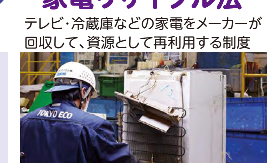
手作業によって冷蔵庫を解体している様子 出典：NEDO
